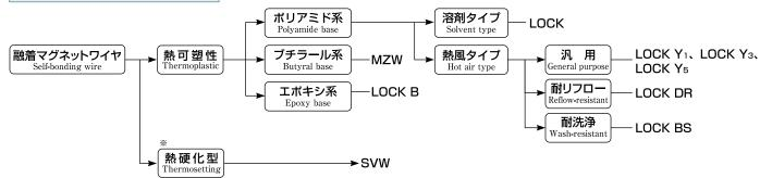
※熱硬化タイプは、巻線後コイルを加熱処理し、熱的に安定な三次元構造の皮膜に変化させるものです。
