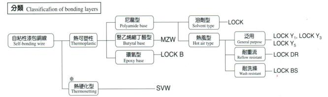
※熱硬化型在捲成線圈後加熱處理,使得熱硬化性皮膜變成三度空間的熱穩定性結構。
